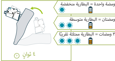
قُم بإمالة القدم بالكامل بزاوية قدرها ٤٠ درجة تقريباً (مع الحفاظ على ثني القدم نحو الأعلى) لتنشيط الـ Bluetooth®. تومض لمبة المؤشر الأيسر مرتين لتشير إلى حالة شحن البطارية (ومضة أو ومضتين أو ٣ ومضات قصيرة)*. *ملاحظة... إذا تم تعطيل وظيفة مؤشر حالة شحن البطارية، فلن ترى مجموعتي وميض حالة البطارية.
