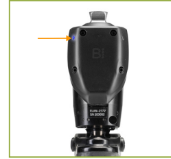
تشير لمبة المؤشر الموجودة على يسار جهاز ElanIC إلى مستوى شحن البطارية الحالي وكذلك حالة الـ Bluetooth®.
